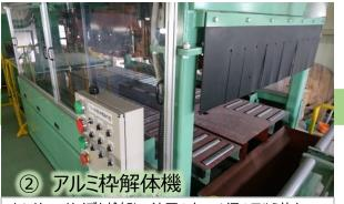
センサーでサイズを検知し、油圧の力で4辺のアルミ枠を 取り外します。
