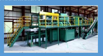
どの設備を利用しても、処理後はジャンクションボックス、アルミ、ガラス、バックシートの 4つに分離されます。
