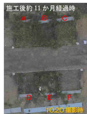
写真4 盛土法面の植生繁茂の推移(植生はA, B, C部に実施, A:鉄鋼スラグA混合土, B:建設残土, C:鉄鋼スラグB混合土)
